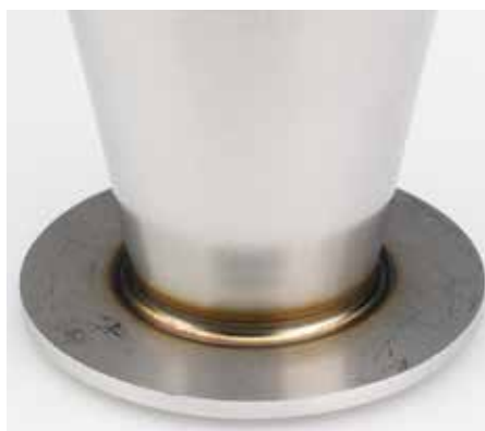
Plasma-keyholelas van 6 mm roestvast staal
