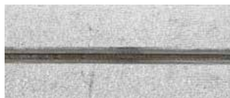
Plasma-keyholelas van 6 mm roestvast staal
