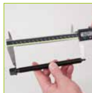
b Meet de draadlengte tot de spindelpunt.
