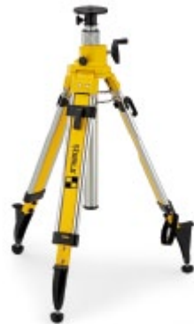
BST-K-L Bouwstatief met luchtgeveerde zwengelkolom, spreidstop en snelsluiting. Hooge: ca. 98 – 220 cm Schroefdraad: 5/8" Gewicht: ca. 6,5 kg
