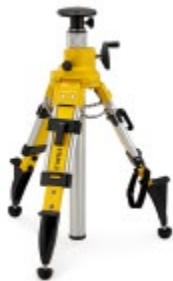
BST-K-M Bouwstatief met luchtgeveerde zwengelkolom, spreidstop en snelsluiting. Hooge: ca. 69 – 170 cm Schroefdraad: 5/8" Gewicht: ca. 6,0 kg
