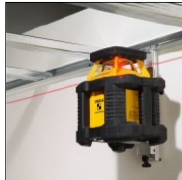
NK 100 Nivelleerconsole Ideaal voor binnenaafwerking: in hoogte verstelbare nivelleerconsole (wanhouder) voor rotatielasers. Wordt aan een profielrail of spijker opgehangen. Toepassingsmogelijkheden: plafonds verlagen, dekvloeren leggen etc.
