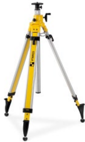
BST-K-XL Bouwstatief met luchtgeveerde zwengelkolom, metrieke schaalverdeling, spreidstop en snelsluiting. Hooge: ca. 118 – 300 cm Schroefdraad: 5/8" Gewicht: ca. 7,3 kg
