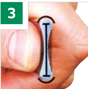
3 Hoge buigvastheid door dubbel-T-profiel
