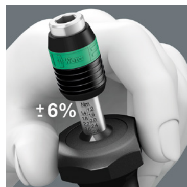
Precisie \pm 6\% conform Norm DIN EN ISO 6789. Duidelijk hoor- en voelbaar kliksignaal bij het bereiken van het draaimoment.
