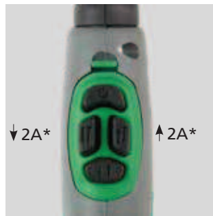
Regelmodule met 4 functies voor het regelen van de lasroom en het activeren van de TIG-A-Tack functie. De lasroom wordt verhoogd / verlaagd met 2 ampère. Lang indrukken voor constante toename / afname. 80300063
