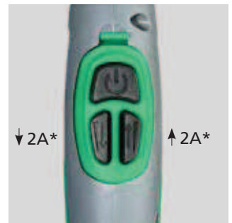
Regelmodule met 3 functies voor het voor het regelen van de lasroom. De lasroom wordt verhoogd / verlaagd met 2 ampère. Lang indrukken voor constante toename / afname. 80300064
